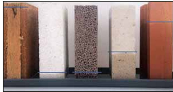
Abb. 3: Wasseraufnahmeverhalten verschiedener mineralischer Wandbaustoffe (© HTW Dresden)
